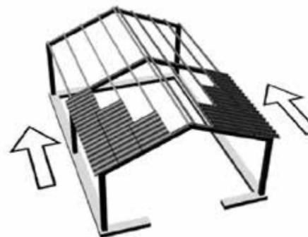
Fig. 38 : Pose classique avec plaques ondulées
