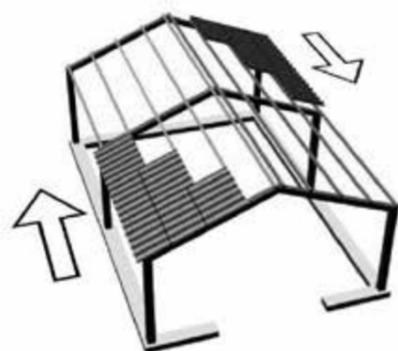
Fig. 11 : Pose circulaire des plaques ondulées
